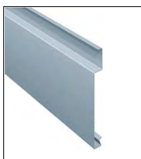
Panel poziomy HZ , niedeklowany, fuga stała 20 mm, szerokość osiowa panela = widoczna część panela + 2 × ½ fugi, dł. stand. 3 lub 4 m
