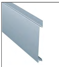
Panel nakładkowy ST , szerokość osiowa panela = widoczna część panela plus 9 mm, długości stand. 3 lub 4 m
